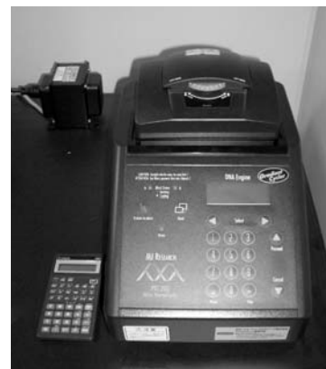
図3 . PCR装置 (プログラム付き温度制御装置) 左はメジャー用の卓上電子計算機
