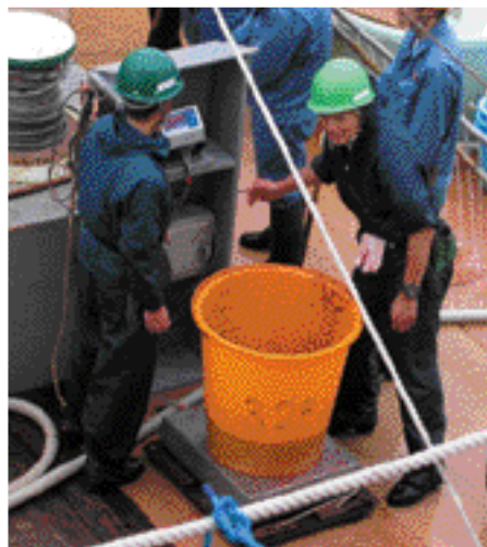
図17. 胃内容物の計量風景。左上の青い箱型のもが表示部。
