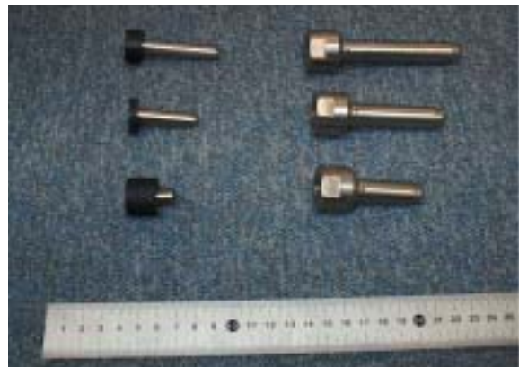
写真2 . 採取器の種類。右：エアーガンシステムの採取器。左：コンパウンドクロスボウシステムの採取器。
