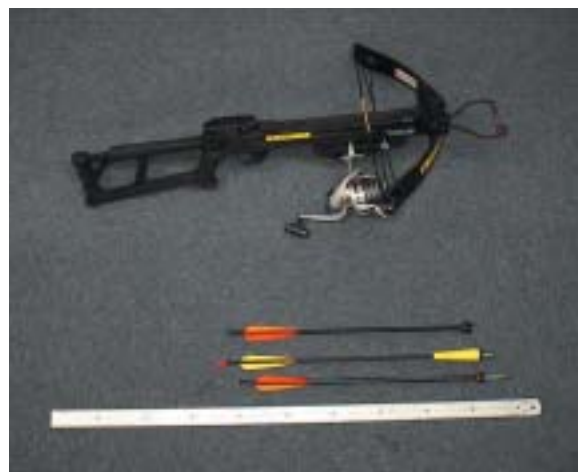
写真3 . 最新のリール付コンパウンドクロスボウ（上）と矢（下：先端部が採取器）。矢はフロート付（タモ網で回収）とリールで回収するタイプがあるが、現在は後者を使用している。
