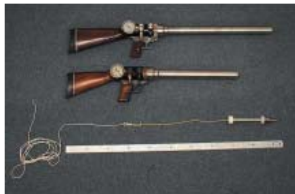
写真1 . エアーガンシステム機材。ICR銃（初期モデル：短銃身（下）、最新モデル：長銃身（上））とロープ付の弾体と採取器（先端部が採取器）。
