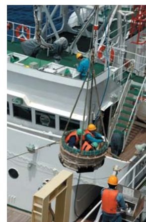
写真8．通常の移乗で使用するクレーンと籠。日新丸から海幸丸へクレーンで籠を降ろしています。クレーンは手前の装置で操作し、人の他に荷物の移動にも利用されます。(2006/07JARPAII)
