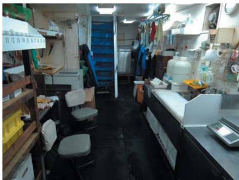
写真1．日新丸のデッキ右側にある調査実験室。左の棚には転落防止の柵が付いていて、ホルマリン保存のサンプルを入れる黄色と青の箱が置いてあります。階段の奥には冷凍サンプル用の超低温槽が、2階にはパソコンや資材が置いてあります。(2007/08JARPAII)
