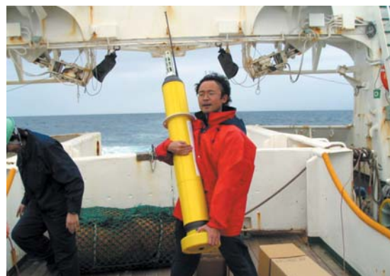
図3. アルゴフロート。海面から水深2,000mまでの水温と塩分濃度を約10日毎に観測し、フロートの先端にあるアンテナより人工衛星にデータを伝送します。
